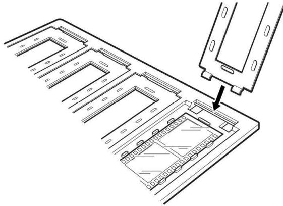
4. 図のように、透過原稿ガイドに合わせてフィルムホルダーをスキャナーの原稿台に置きます。
