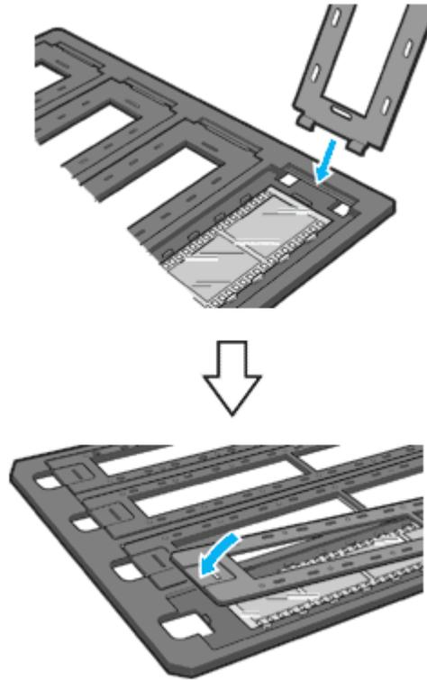
2. 透過原稿ユニットを開けます。フィルムのベース面が下になるように、フィルムホルダを原稿台にセットします。
