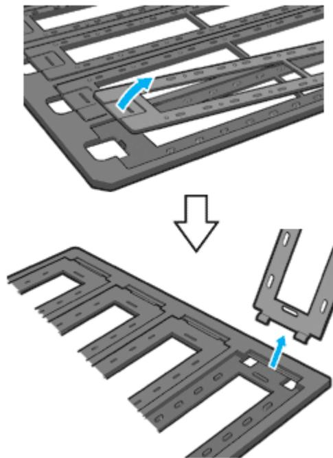
2) フィルムのベース面(像が正しく見える面)を下に向けてセットします。
